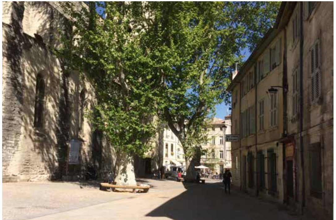
Contrairement à l'enrobé, le béton désactivé permet de signifier au sol le caractère piéton de la place.
