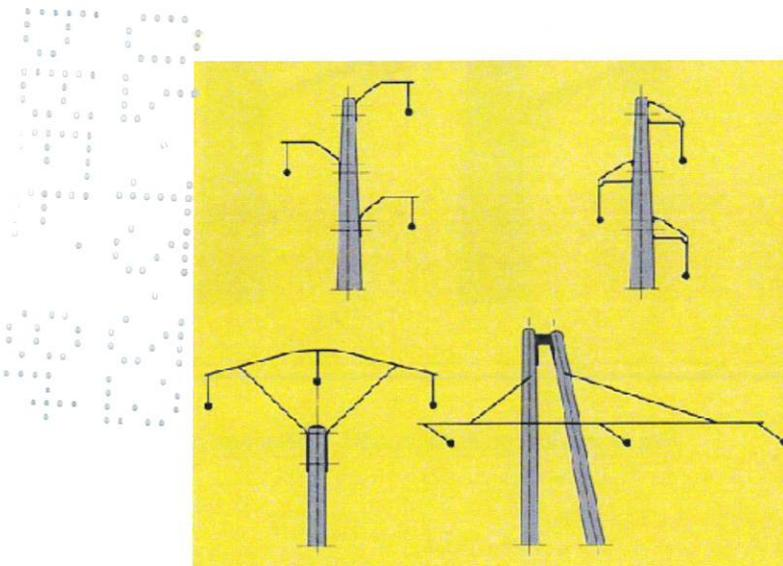
Figure 4 : Réseau électrique HTA nu - Technique suspendue
